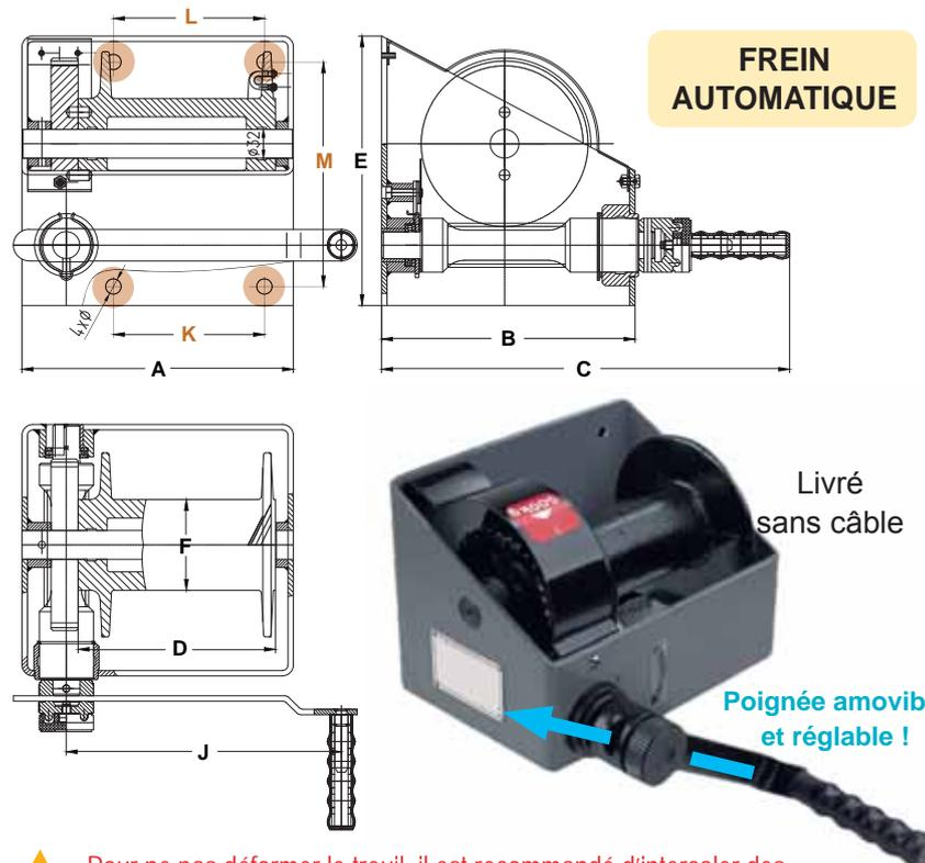
! Pour ne pas déformer le treuil, il est recommandé d'intercaler des rondelles plates entre votre plan de fixation et la plaque du treuil.
