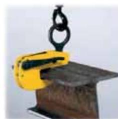
Levier de verrouillage (blocage de sécurité)
