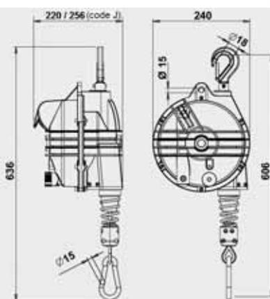
Suspension rotative par crochet de sécurité
