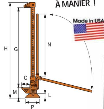
Levier à système d'engrenage à cliquet
