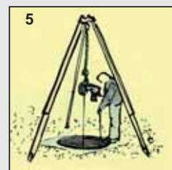
5 Levage de charge au-dessus d'un puits
