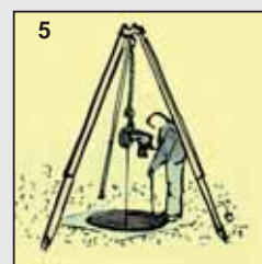
Levage de charge au-dessus d'un puits
