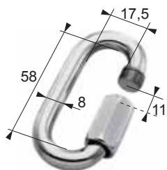
CMU : 700 kg Acier zingué Coef. sécu. 1/5 Poids : 0,078 kg
