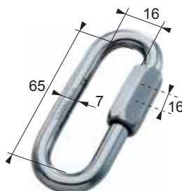
CMU : 500 kg Acier zingué Coef. sécu. 1/5 Poids : 0,062 kg
