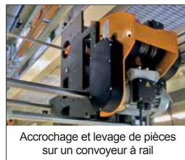
Accrochage et levage de pièces sur un convoyeur à rail
