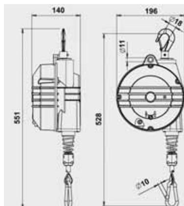
Suspension rotative par crochet de sécurité
