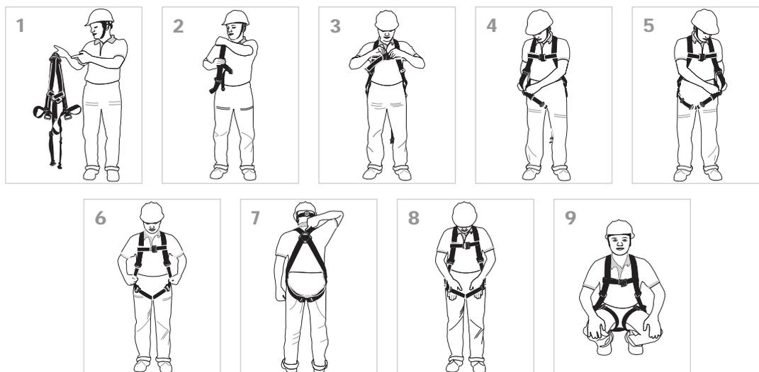
Pour utiliser une ceinture de maintien au travail et une longe correctement il suffit de suivre les étapes suivantes :
