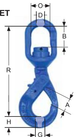
! NON-CONÇU POUR PIVOTER SOUS CHARGE !
